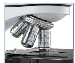
● l'objectif Plan S100x avec diaphragme à iris intégré
